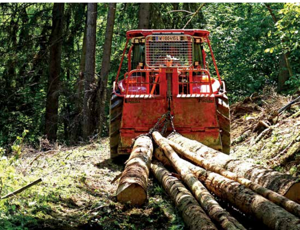
Die Seilwinde im Einsatz im bäuerlichen Kleinwald – trotz technischer Neuerungen bleibt sie ein zentrales Arbeitsmittel.
