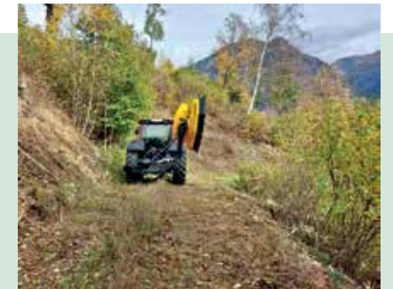
Mit dem Kronos Predator 1700 M können Böschungen effizient gepflegt werden.
