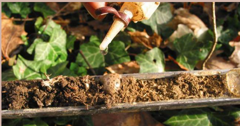
↑ Abbildung 01: Karbonathaltiges Material braust, schäumt und knistert beim „Salzsäuretest“ – die Reaktion ist umso stärker, je höher der Karbonatgehalt ist, lediglich Dolomit reagiert etwas verhaltener. (Foto: BFW/Rainer Reiter)
