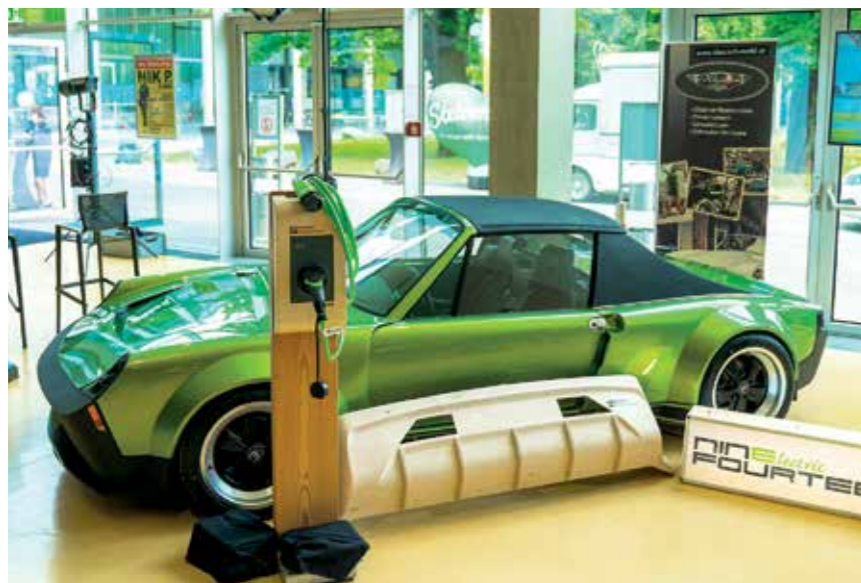
Innovationen, auf Holz gebaut: Die Stoßstange des neuen Porsche 914electric aus Holz ist leicht, formstabil, regional und CO 2 -speichernd.
